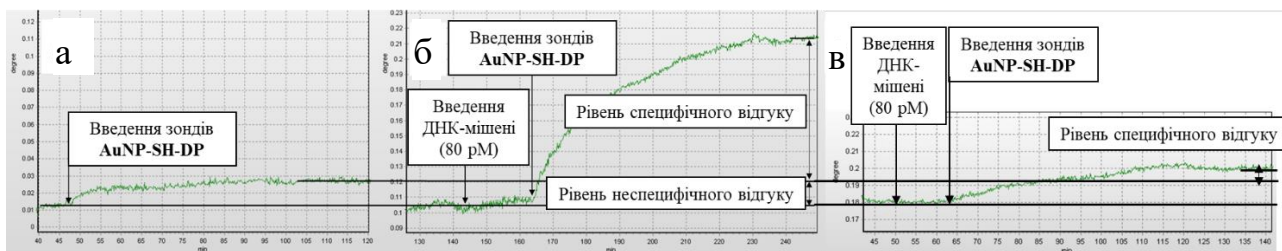
Рис. 3.28. (а) Неспецифічний відгук біосенсора за відсутності одноланцюгових ДНК-мішеней у вимірювальній комірці; (б) відгук біосенсорної системи на ін'єкцію ДНК-мішені 80-мер BCR–ABL (80 нМ) у вимірювальну комірку з подальшим введенням AuNP–SH–DP; (в) відгук біосенсора на введення ДНК-мішені 80-мер BCR–ABL (80 пМ) у вимірювальну комірку з подальшим введенням AuNP–SH–DP. Гібридизаційне середовище: 2×SSC; концентрація AuNP-SH-DP: 450 пМ; вісь у: відгук ППР (градуси, °); вісь х: час (хв)
