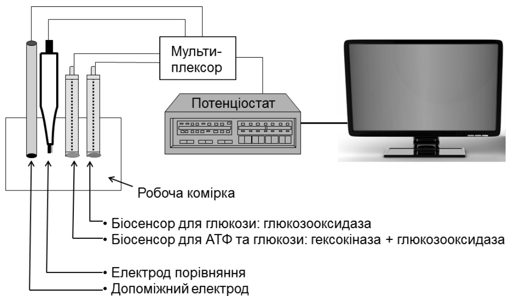
Рис. 4. Схема біосенсорної системи на основі двох біосенсорів для одночасного визначення концентрації глюкози та АТФ
