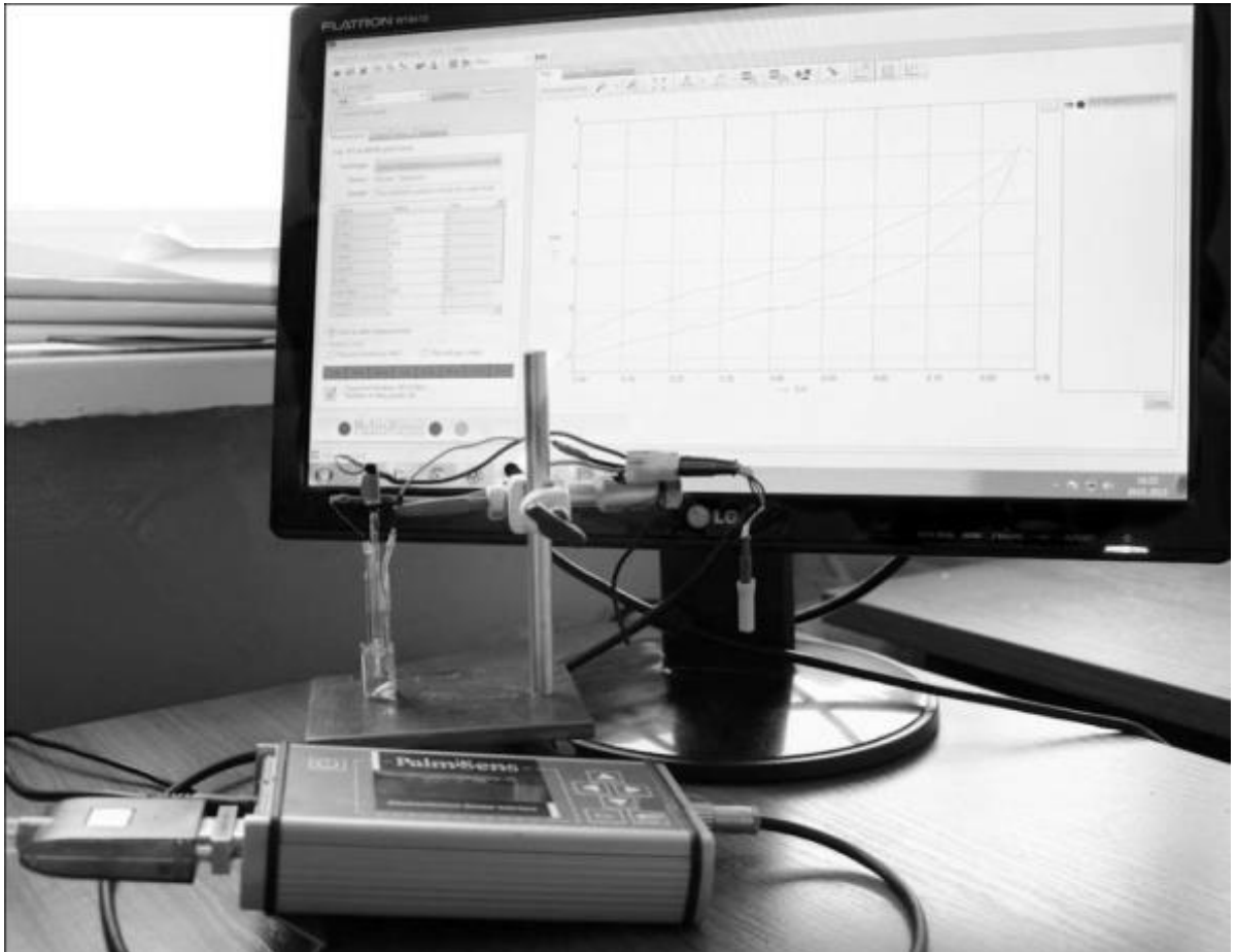
Рис. 2.3. Зовнішній вигляд вимірювальної установки для амперометричних вимірювань
