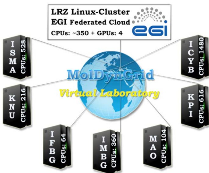
Рис. 3. Обчислювальні ресурси віртуальної лабораторії MolDynGrid. Станом на 2016 рік під'єднано 9 ресурсних центрів загальною кількістю ~2500 процесорних ядер, з яких 2 кластера належать до EGI: Leibniz-Rechenzentrum Linux-Cluster (Німеччина) та EGI Federated Cloud (федеративний “хмарний” ресурсний центр) з графічними прискорювачами
