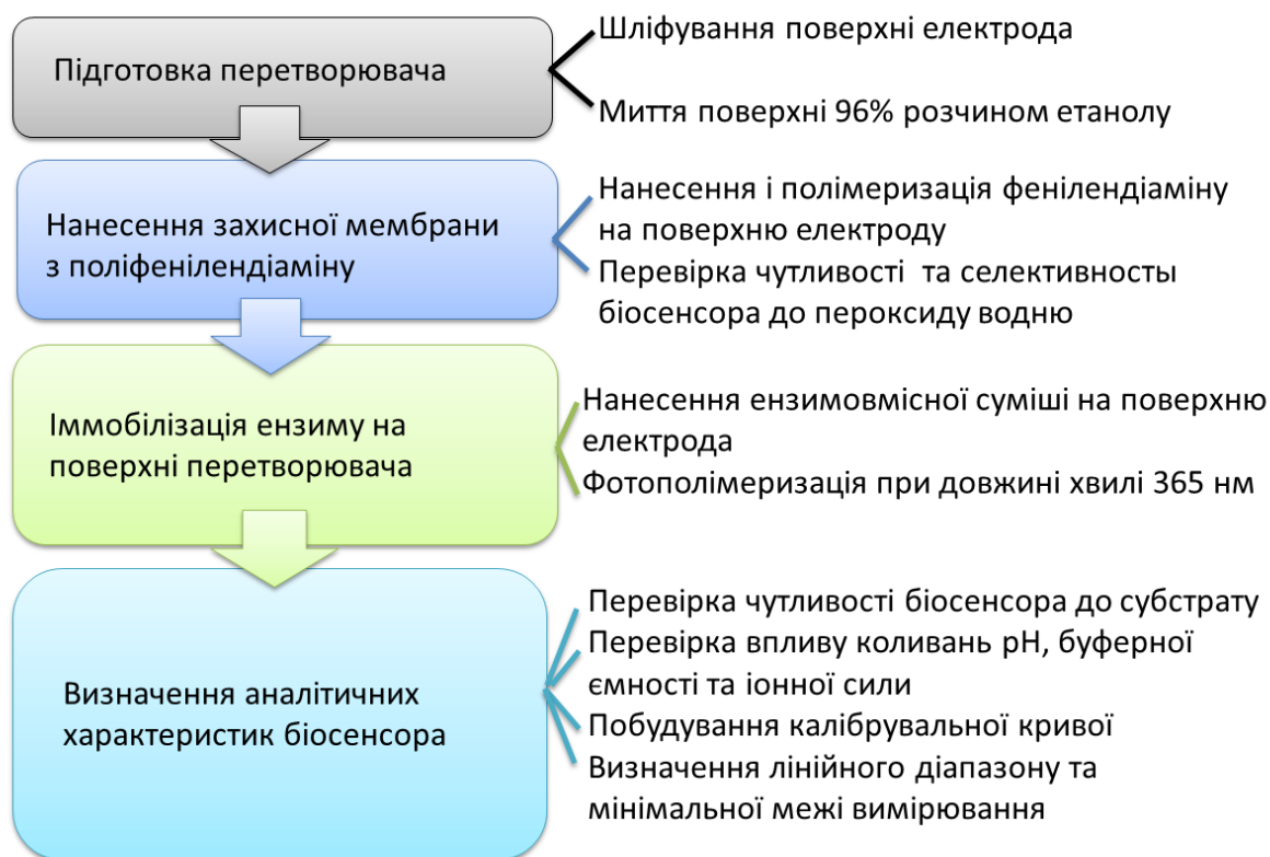
Рис. 7.1. Схема етапів виготовлення лабораторного прототипу монобіосенсора для визначення концентрацій лактату або пірувату
