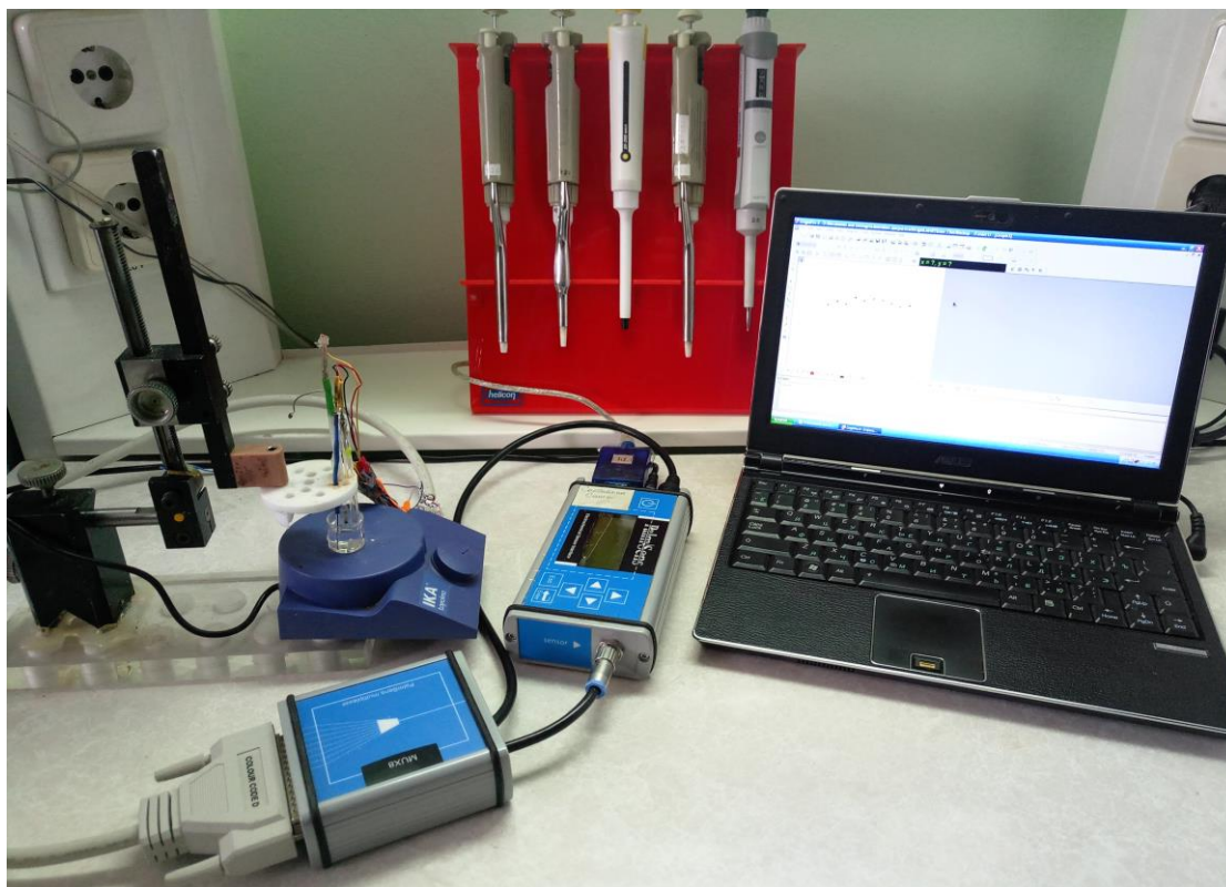
Рис. 2.4. Зовнішній вигляд вимірювальної установки для амперометричних вимірювань
