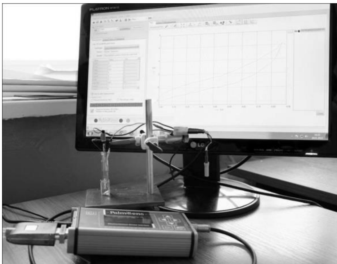
Рис. 2.10. Зовнішній вигляд вимірювальної установки для амперометричних вимірювань.
